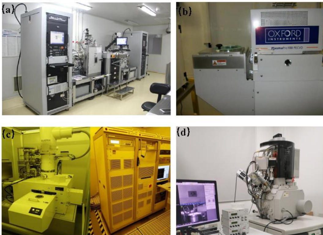
图 2.4 (a) KJL PVD75 型电子束蒸发机和磁控溅射机仪器示意图；(b) OXFORD 100 型 PECVD 设备示意图；(c) 电子束曝光设备示意图；(d) FIB 双束电镜设备示意图。
