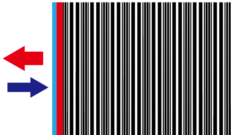
图 3.16 光学莫尔超晶格-金属构型。蓝色表示 20 nm 金属银层，红色表示混有量子点的 PMMA 介质层。右侧黑白条纹表示 H^2(z) 对应的光学莫尔超晶格。蓝色箭头泵浦激光激发入射方向，红色箭头表示量子点荧光发射方向。
