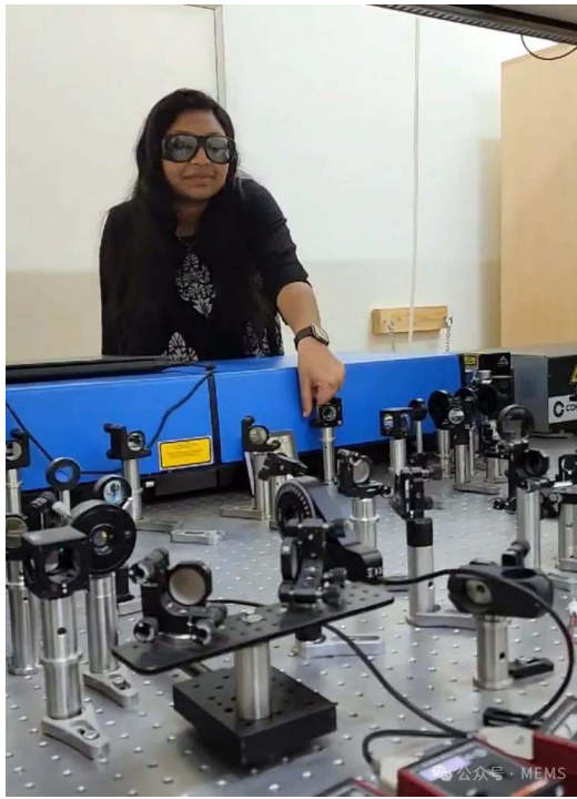
Varun Raghunathan正在对准光束进行红外光上转换实验
